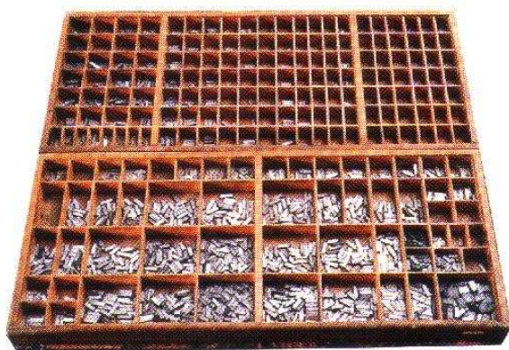
Σχῆμα 11: Κάσα χειροστοιχειοθεσίας, λίγο πριν αρχίσουν να χρησιμοποιούνται μηχανικές μέθοδοι για τη στοιχειοθεσία.
