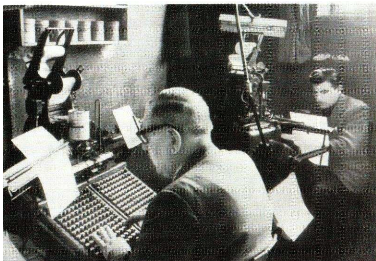
Σχήμα 13: Μηχανή μονοτυπίας με το σχετικό χειριστή της -πάντα με γραβάτα και πνιγμένο στον καπνό του τσιγάρου!
